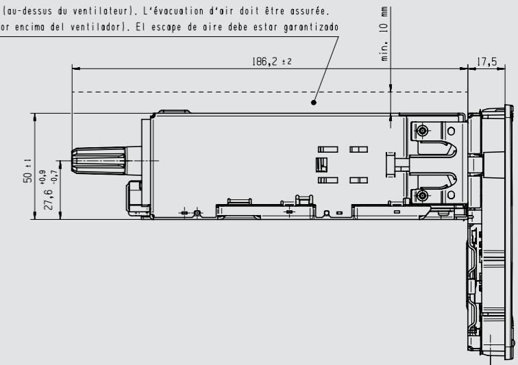
Einbauposition: Einbauwinkel ±15° zulässig
